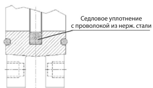
Данная конструкция обеспечивает исключительно ровную посадку уплотнения, без внутренних полостей, и препятствует скапливанию твердых отложений в области уплотнения.
